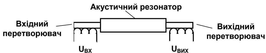
Рис. 4.10. Елементи магнітострикційного перетворювача
